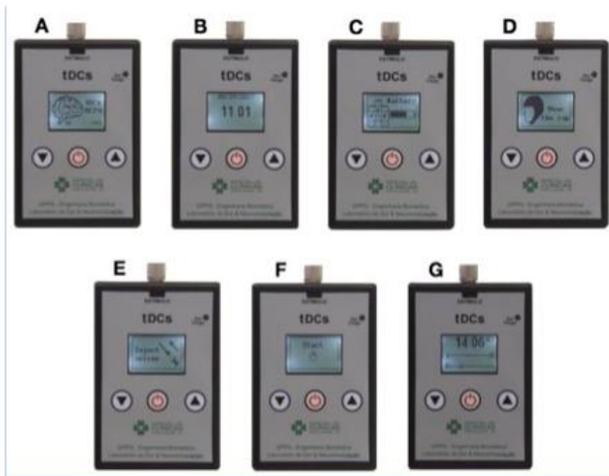
Figura 3. Aparelho de ETCC de uso domiciliar. (A) Tela de abertura. (B) Dia e hora. (C) Estado da bateria. (D) Comando “colocar a touca”. (E) Comando “injetar salina”. (F) Comando para iniciar a sessão. (G) Início da estimulação. Figuras retiradas de Carvalho, Brietzke (82).
